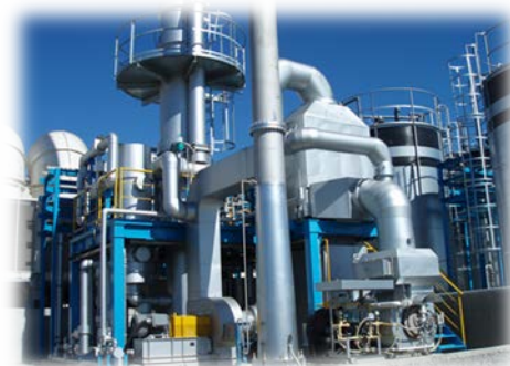
アンモニア処理システム アンモニアの回収 アンモニアの無害化(触媒脱臭)
